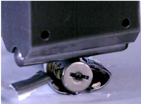
Mit einer Hochgeschwindigkeitskamera aufgezeichneter Fallhammerversuch: Der Schliesszylinder des Kabelschlosses ging bereits beim ersten Hammerschlag zu Bruch.
