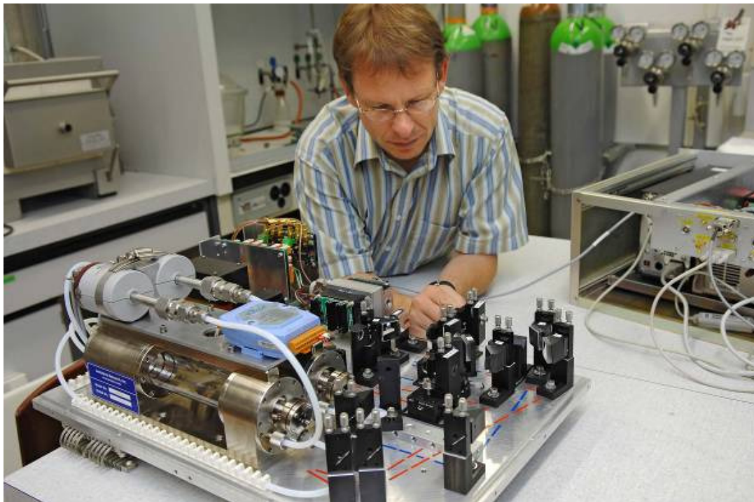
Lukas Emmenegger beim Einstellen und Kalibrieren des CO 2 -Isotopenmessgeräts.
