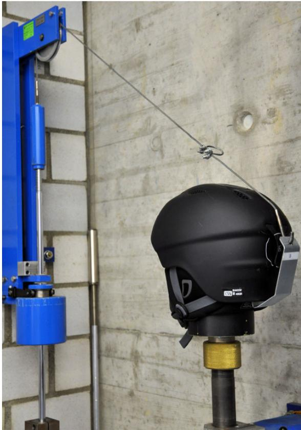
Beim Abstreifttest wird überprüft, ob das Kinnband in jedem Fall einen korrekten Sitz des Helms garantiert.
