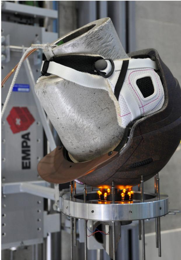
Bei der Fallprüfung wird ein Aufprall mit 20 Kilometern pro Stunde simuliert.
